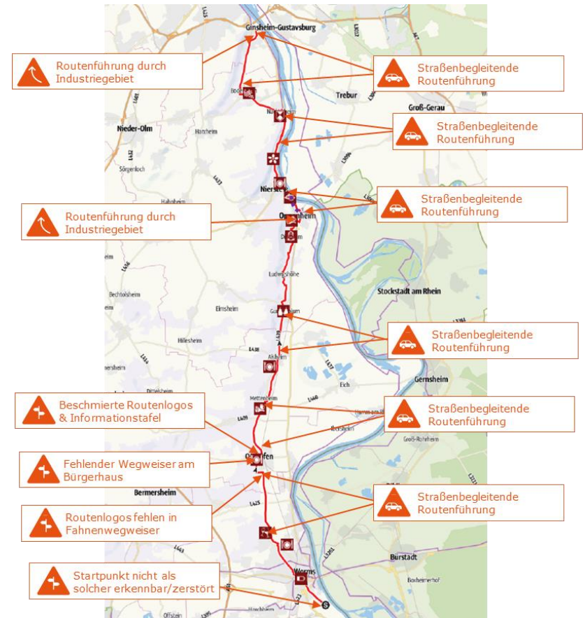
© BTE 2019: Dokumentation der Basisqualität basierend auf der Befahrung der Rheinterrassenroute
